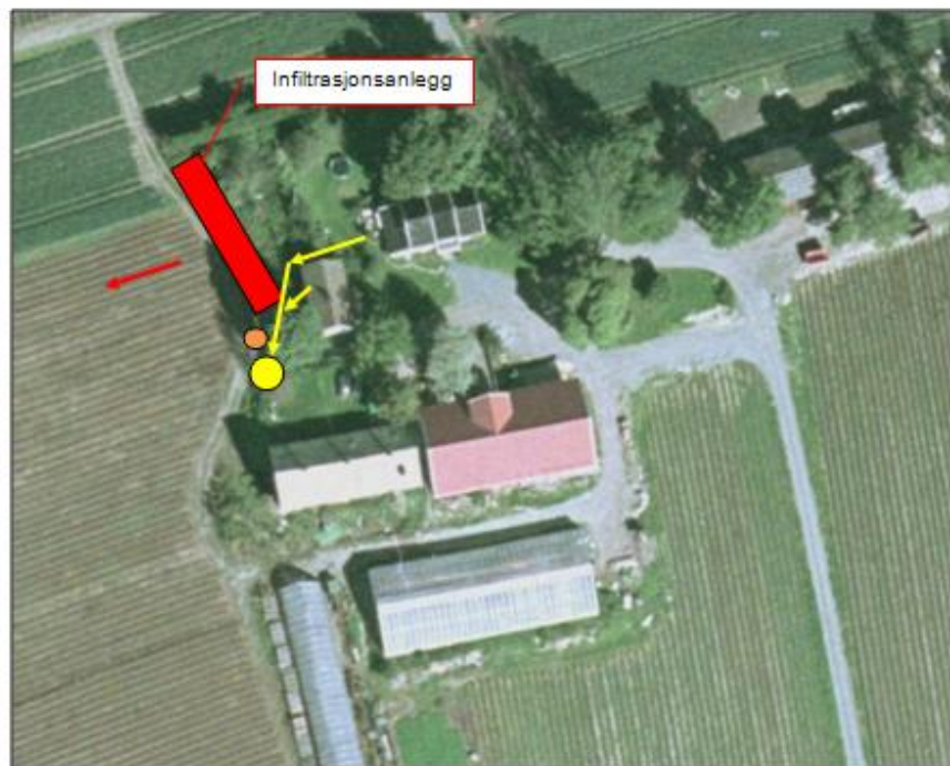
Figur 2: Lokalisering av infiltrasjonsanlegg for 15 pe. Slamavskiller vist med gul sirkel. Pumpekum vist med oransje sirkel. Strømningsretning for infiltrert avløpsvann vist med rød pil.
